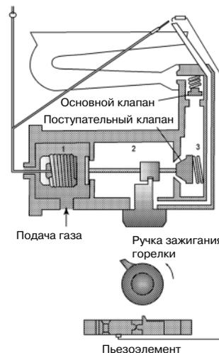
Перевод ручки управления в положение зажигания (положение ↗) вызывает:
